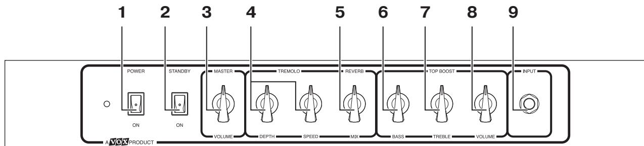
**1. Переключатель Power:** Служит для включения и выключения питания усилителя. Перед перестановкой усилителя убедитесь, что прибор выключен и отключен от сети электропитания.
